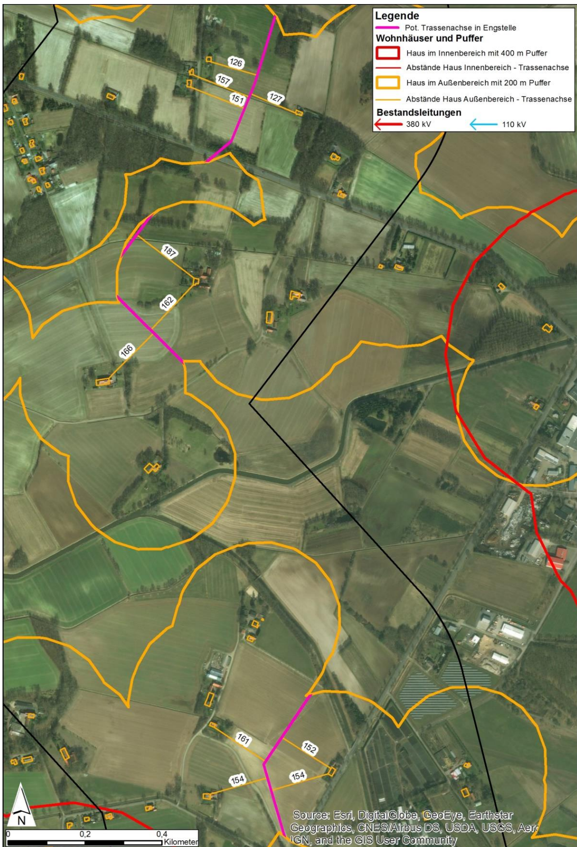
Abb. 28 Abstände zu Wohngebäuden der Engstelle Nr. 11- Westlich Quakenbrück
