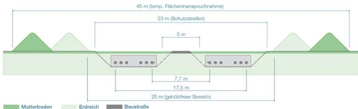
Abb. 5 Schematische Darstellung des Erdkabelgrabens
