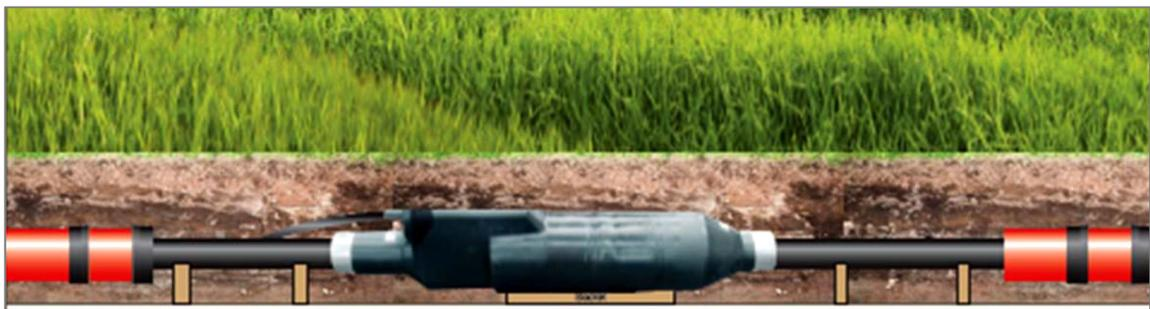
Abb. 10 Kabelmuffe, exemplarische Darstellung (Quelle: Amprion)
