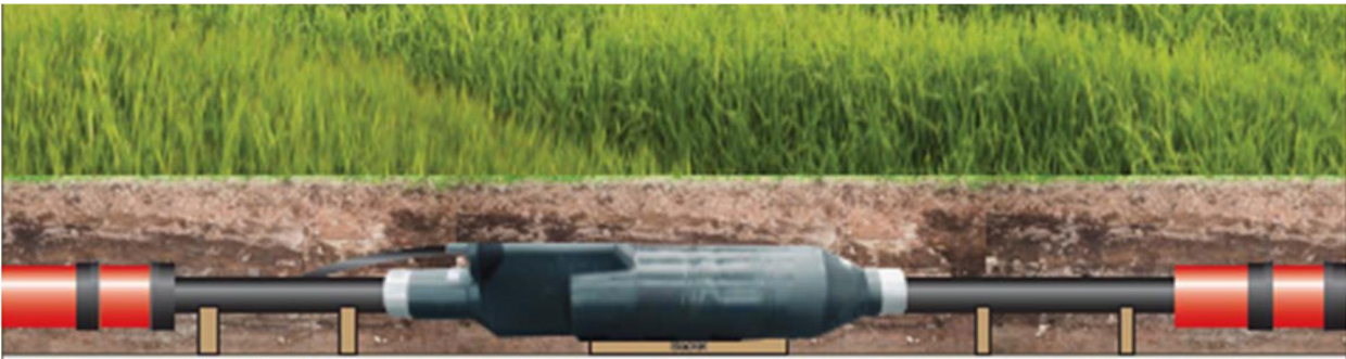
Abbildung 15: Kabelmuffe, exemplarische Darstellung (Quelle: Amprion)
