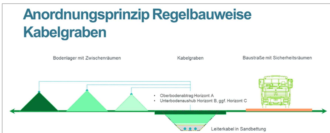
Abbildung 7: Anordnungsprinzip Regelbauweise Kabelgraben (Arbeitsstreifenbreite 25-30 m bei einem System (Quelle: TenneT Offshore GmbH)
