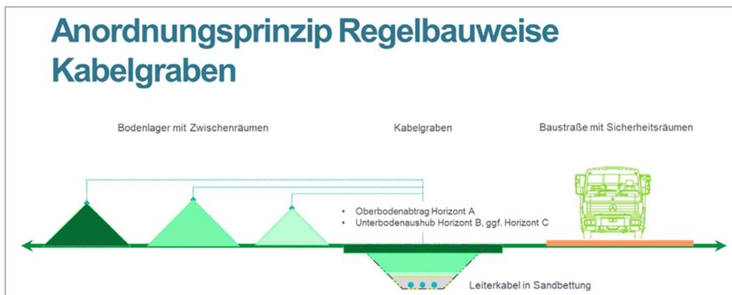
Abbildung 3: Anordnungsprinzip Regelbauweise Kabelgraben (Arbeitsstreifenbreite 25-30 m bei einem System (Quelle: TenneT Offshore GmbH)
