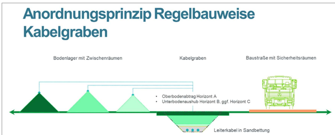
Abbildung 5: Anordnungsprinzip Regelbauweise Kabelgraben (Arbeitsstreifenbreite 25-30 m bei einem System (Quelle: TenneT Offshore GmbH)
