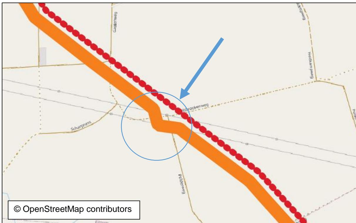
Abbildung 1: Kleinräumiges Abweichung der Trassenskizze LanWin1 und LanWin3 (in orange) von der planfestgestellten Trasse BorWin5 (in rot) auf Grund eines Strommastes.
