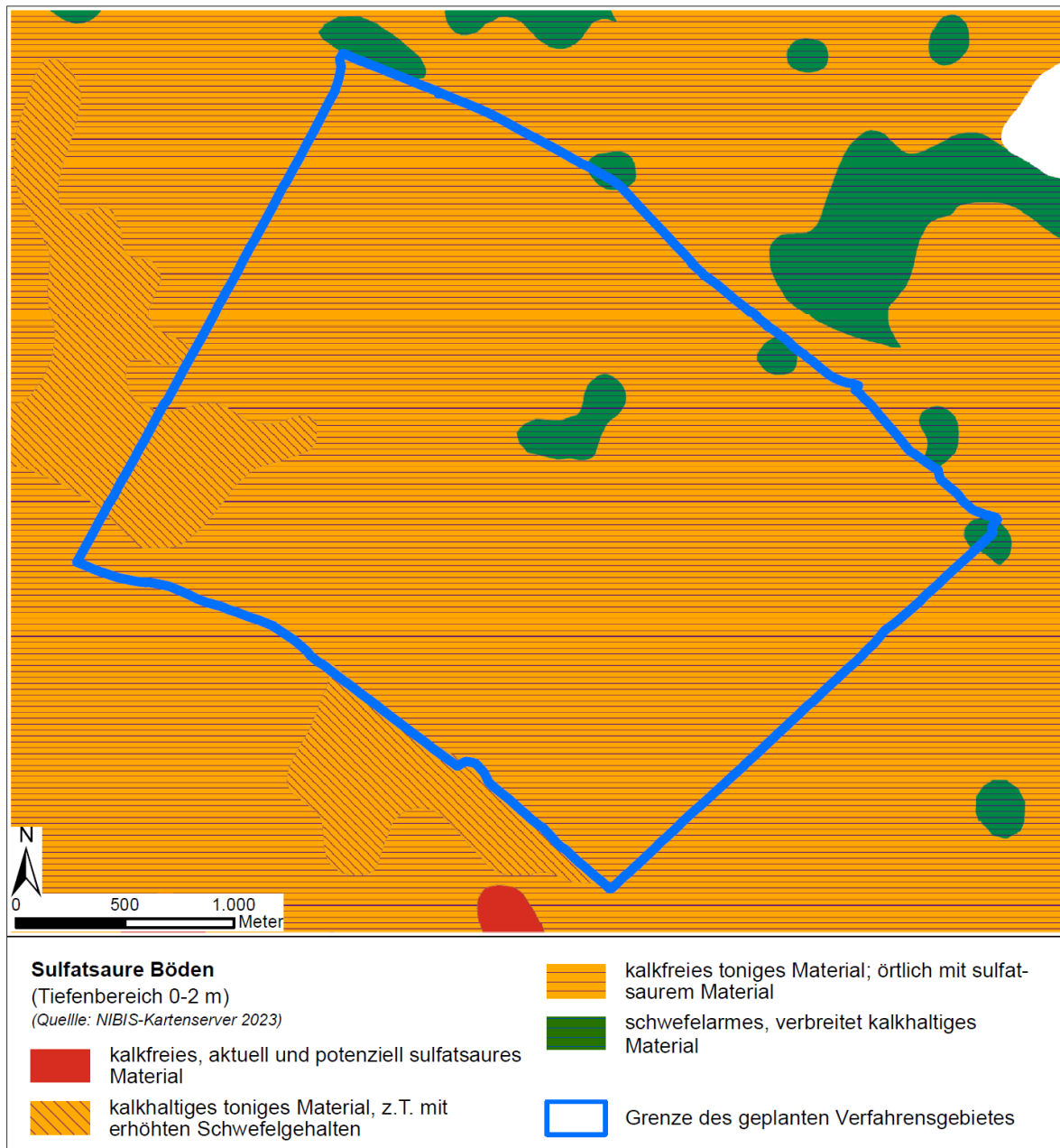
Abb. 5: Sulfatsaure Böden (Tiefenbereich 0 bis 2 m)
